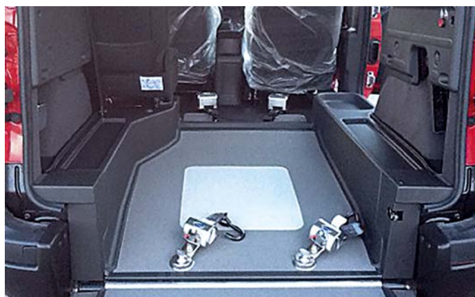
Kangoo nach der Umbauphase: Über eine Rampe wird der Rollstuhl in den hinteren Teil des Kangoo geschoben, wo er nach dem Umbau bequem Platz findet. Beachten Sie die Arretierungspunkte für den Rollstuhl.
