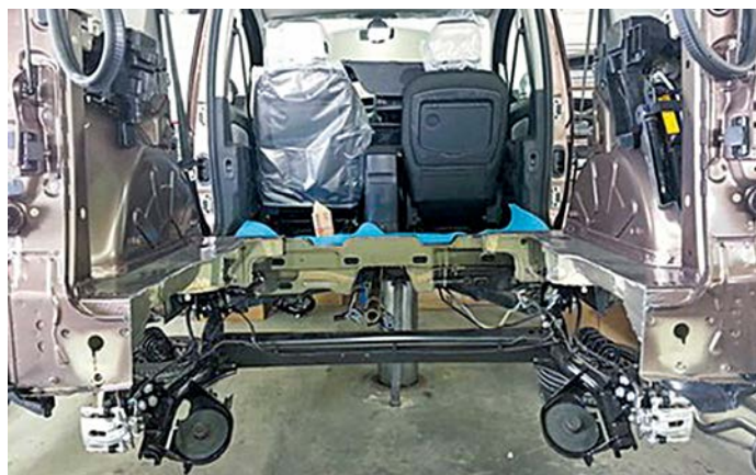
Kangoo in der Umbauphase: Vorbereitung eines Renault Kangoo für den Einbau eines Transportsystems für Rollstuhlfahrer.
