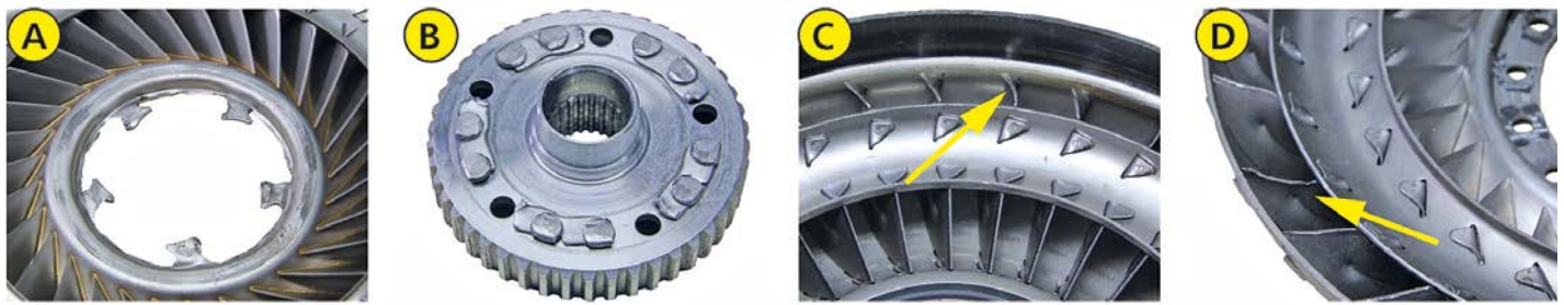
Bild 3. Mögliche Defekte an Drehmomentwandlern: A und B Nabendefekt, C und D beschädigte Schaufeln am Pumpenrad und Turbinenrad.
